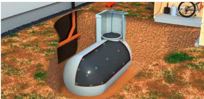
Tankschutzfachbetriebe setzen die auf Maß gefertigte neue Innenhülle in den Tank ein, anschließend wird sie aufgeblasen und hält dank der integrierten Magnete dauerhaft fest am Tank.
