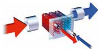
In den Industrie-Wärmetauschern von Schröder wird das heiße Abgas an einem Rohrbündel vorbeigeführt. Dabei erhitzt sich das durchgeleitete Wasser.
