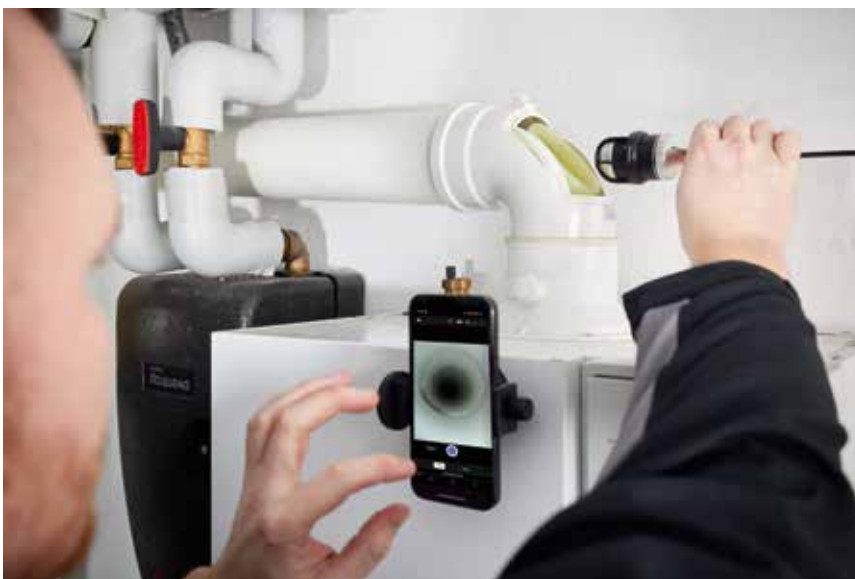
Schnell einsatzbereit: Für die Überprüfung wird nur die Wöhler SI 400 Smarte Inspektionskamera, eine passende Haspel und ein Smartphone benötigt.
